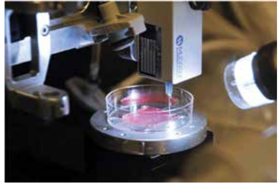
Figura 2. Bioimpresión tridimensional de tejidos. La bioimpresión 3D de tejidos será importante porque permitirá crear tejidos y órganos artificiales para trasplantes y para probar medicamentos en condiciones más cercanas a las del cuerpo humano. Su futuro es prometedor ya que se están investigando nuevas formas de imprimir tejidos más complejos y funcionales, lo que podría revolucionar la medicina regenerativa (imagen tomada de https://www.nytimes.com/2020/07/27/science/bioprinting-covid-19-tests.html )
